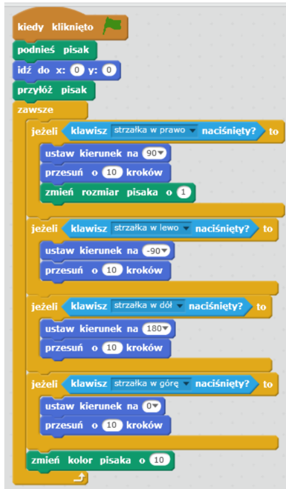
Rysunek 5 Jeżeli dodamy na końcu skryptu polecenie zmień kolor pisaka o ... to duszek będzie zostawiał za sobą kolorowy ślad. Jeżeli dodamy polecenie zmień rozmiar pisaka o .... w części odpowiedzialnej za poruszanie się duszka w prawo, to przy każdym przesunięciu duszka w prawo ślad pisaka będzie coraz grubszy.
